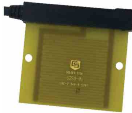
Capteur de mouillure de feuille (Campbell 237)
